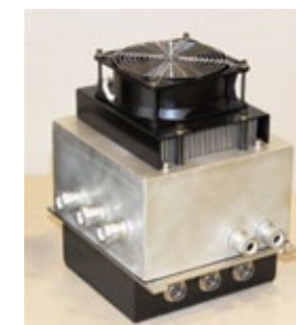
搭載している 駆動用インバータ
